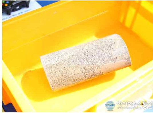
20일 경기 안성에 소재한 국립한경대학교(총장 태범석)는 기존 경량 콘크리트의 단점을 보완하고 단열 온도 조절 기능 등을 더한 차세대 건축부자재 'PCM 콘크리트 패널' 개발에 성공했다고 밝혔다. (사진은 한경대가 개발한 PCM 콘크리트 패널). (사진제공=한경대)
