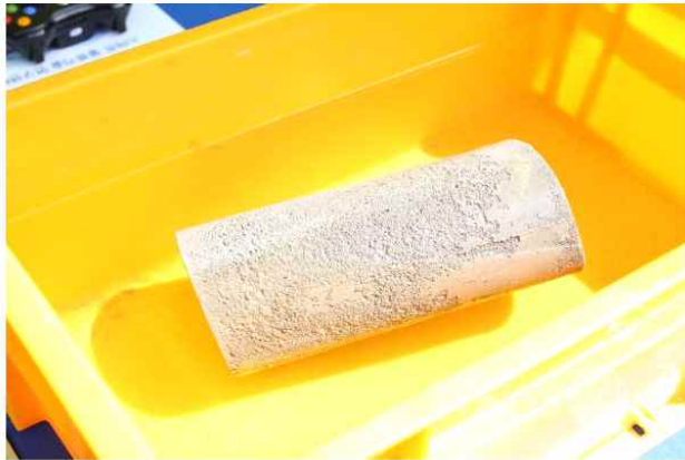
▲국립한경대에서 개발한 ‘PCM 경량 콘크리트 패널’ ©안성뉴스24
