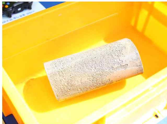
[사진-올해 띄웠는 경량콘크리트]
